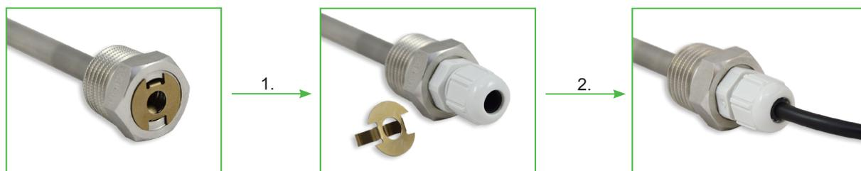
1. Le ressort à l'intérieur du doigt de gant doit être retiré et remplacé par un presse étoupe standard M12x1.5 (non inclus dans la livraison en standard)
